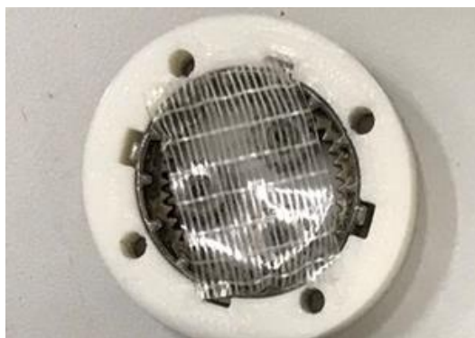
รูปที่ 48 Ring gear และ Planet gear module 0.635
