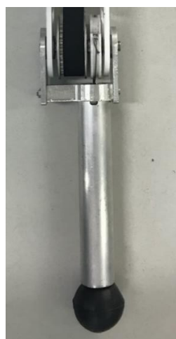
รูปที่ 29 แสดงขาส่วนล่างที่ทำจากอะลูมิเนียม
