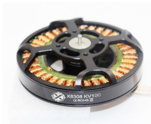
รูปที่ 46 X8308 Brushless motor
