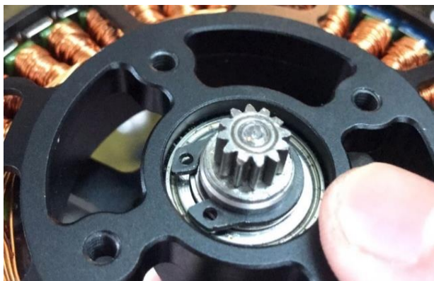
รูปที่ 47 Sun gear module 0.635
