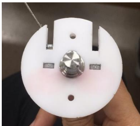
รูปที่ 39 ต้นแบบที่ 1 ของการตัวจับอนุกรมที่มีความ ยืดหยุ่นที่ข้อต่อล่าง
