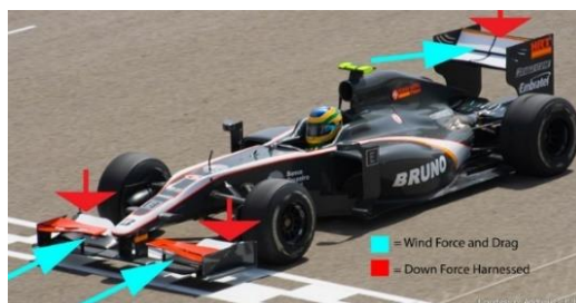
รูปที่ 2 แสดงทิศทางของแรงต้านอากาศ
